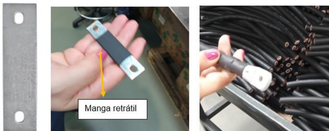
Figura 13 – Exemplo de união e cabo de cobre cravado com terminais na extremidade
